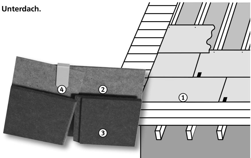
**PAVISO vereinigt die Vorteile von zwei bewährten PAVATEX-Produkten: Das Unterdachelement ① besteht aus einer Hartfaser- ② und einer bituminierten Weichfaserplatte ③ sowie den PAVISO-Überlappungsklammern ④.**
